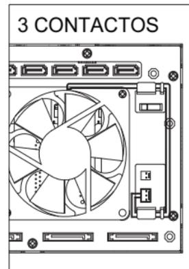
Colocación de los cables del ventilador
