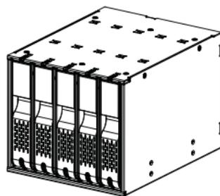
(Inserte la unidad con los conectores SATA orientados hacia el lado derecho del dispositivo.)
